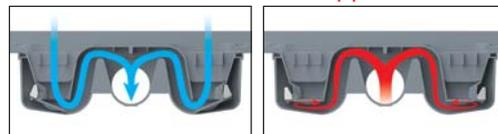
Заслонки открываются при прохождении воды сифоном и обеспечивают её отток.
